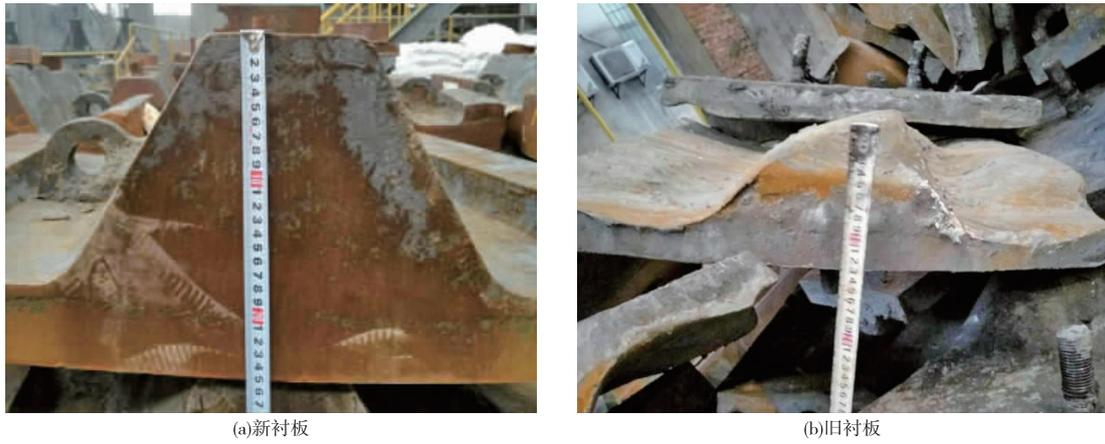
图 3 某选矿厂半自磨机新、旧衬板磨损情况比较
